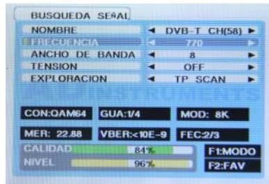
La pantalla de parámetros de modulación permite conocer todos los detalles de la transmisión.
