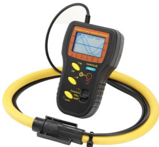
La AD6810 es la primera pinza flexible de análisis de armónicos del mercado para sistemas monofásicos y trifásicos balanceados. Es un analizador de redes destinado a los electricistas y a los servicios de mantenimiento. Dispone de una multitud de medidas y permite capturar eventos transitorios.
