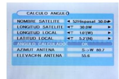
Introduzca su posición GPS y el equipo le calculará la elevación y el azimut de la antena parabólica.
