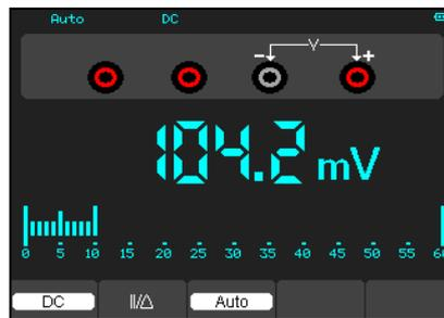
Los DS1000P incorporan multimetro de 6.000 cuentas con aislamiento de las entradas del osciloscopio.
