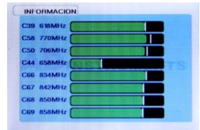
La función de análisis simultáneo permite visualizar los niveles de señal de 8 canales a la vez.
