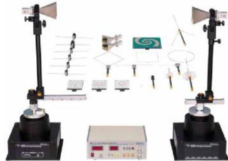
El ED-3200 incorpora 16 tipos de antena y tres fuentes de señal a 500 MHz, 2 GHz y 10 GHz.
